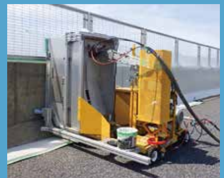
③ STスインガー（自動塗装装置）
